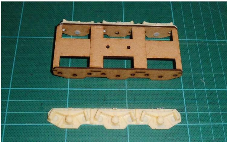
Das Drehgestell wird gespachtelt, die Blenden aufgeklebt und grundiert.
