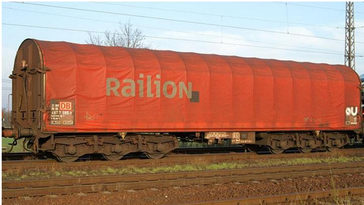
Dieser Wagen ist bei Graaf 1991 entwickelt worden als Coil Transport Wagen mit sieben Lademuellen. Der Wagen ist ausgelegt mit Schiebepalenhaube für den Transport von Wasserentpfindliche Güter.
