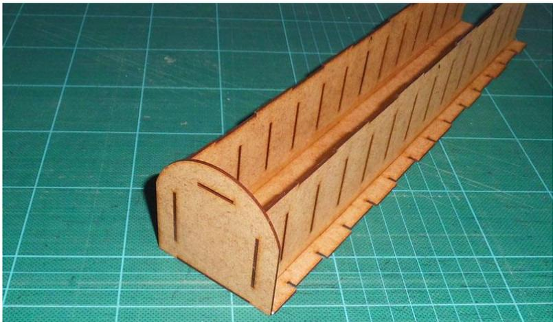
Auf diesen entstandenen Innerkörper werden an die Seite „Rippen“ eingeklebt in den vorgesehenen Schlitten, wobei die gleiche Umrandung entsteht als die Stirnseiten.
