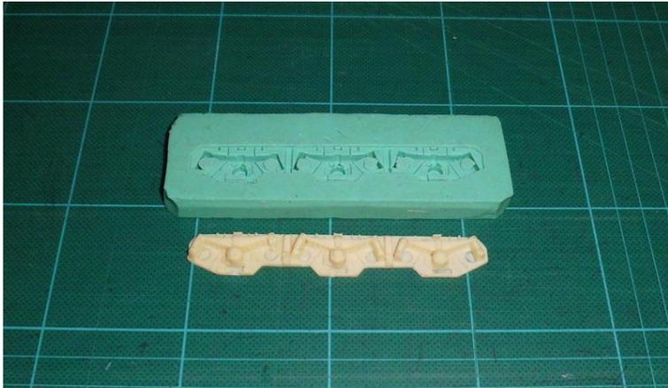
Das Drehgestell in MDF wird zusammengebaut und die Blende entgratet.
